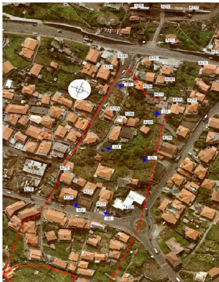
Figura 13 – Planta de localização dos alvos topográficos e dos inclinómetros adicionais na massa deslizante
